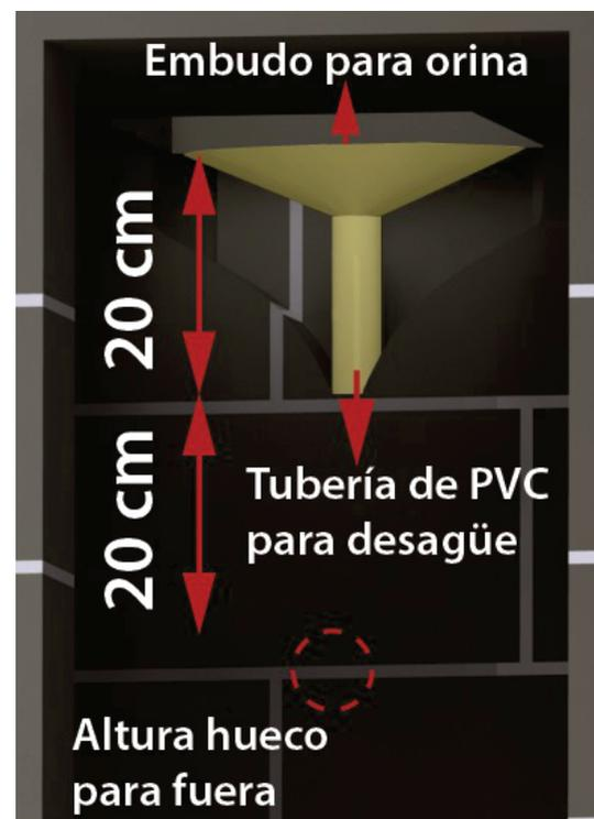
Figura 55: Instalación para evacuar la orina
