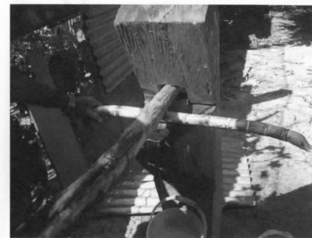
Trapiche de madera que se utiliza como mecanismo artesanal para el procesamiento de la caña de azúcar.
